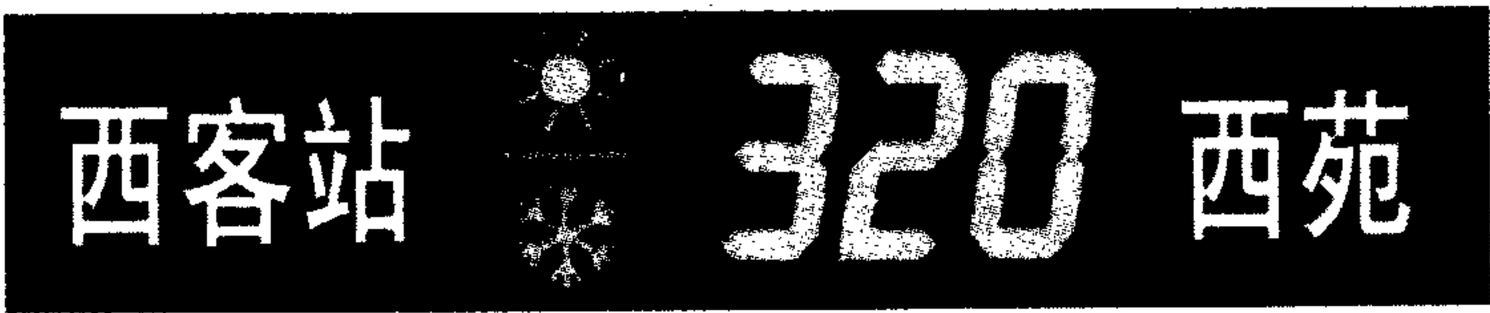
图 C.3 电子显示侧路牌(基本信息和扩展信息带空调标志)
