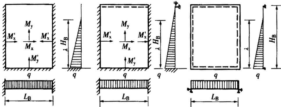
(a) 三边固定、顶端自由 (b) 三边固定、顶端铰支承 (c) 四边铰支承
