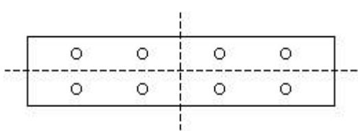
图 3：条缝形风口测点布置
