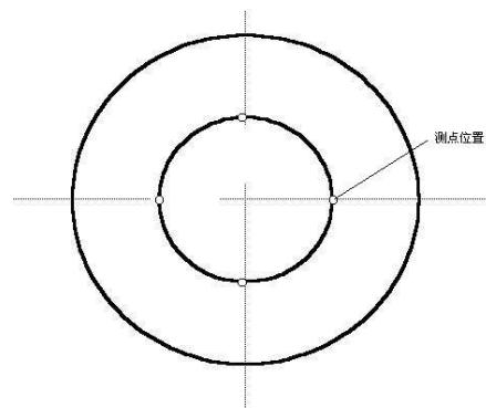
图 4：圆形风口测点布置
