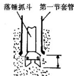
图 6.1.1.3 在硬砂层及卵石层中的挖掘方法
