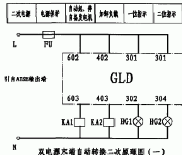
双电源末端自动转换系统图 (一)
