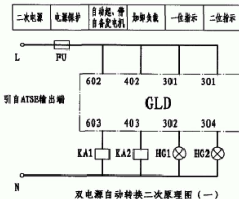
双电源自动转换旁路系统图 (一)
