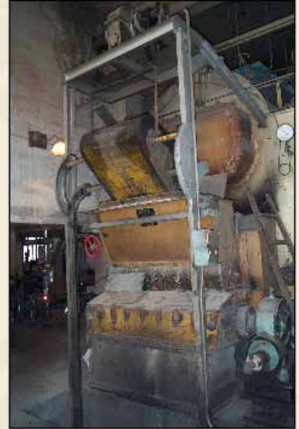
KZL4锅炉输送机(提升机)提升固体燃料
