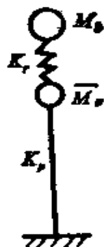
图3.6 全橡胶支座连续梁桥
